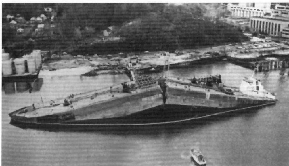
Figura 19: Fratura em estrutura naval devido à fadiga
