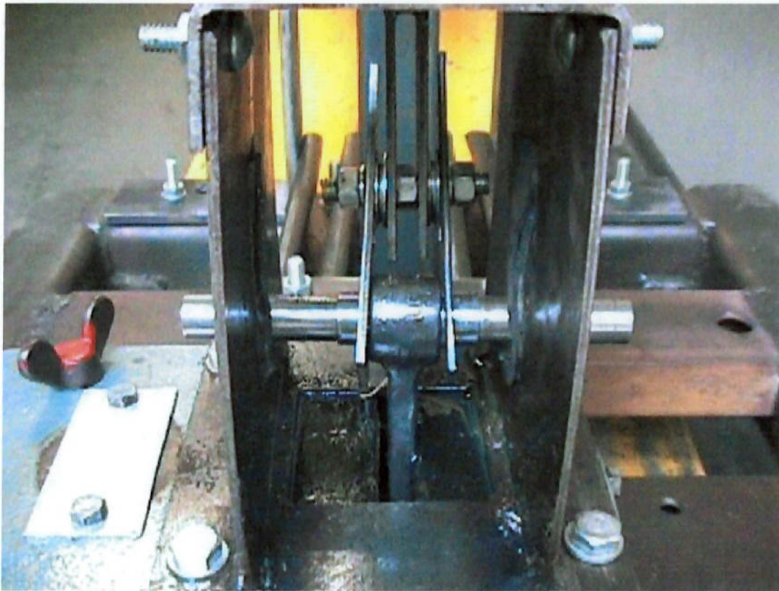
Figura 34: Máquina de ensaios – eixo da biela e espaçadores
